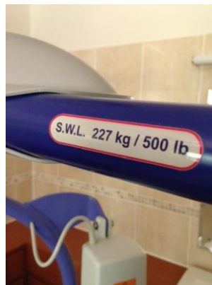
S.W.L displayed on hoist
